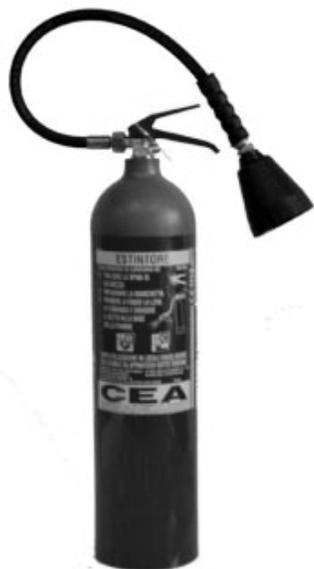
Gli estintori a CO<sub>2</sub> sono costituiti da una bombola collaudata e revisionata ogni 5 anni dall'ISPESL (ex ANCC) - per una pressione di carica, a 15°C. a 250 ate; da una valvola di erogazione a volantino o a leva e da una manichetta snodata - rigida o flessibile - con all'estremità un diffusore in materiale isolante.
