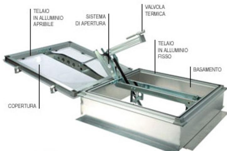
Tali sistemi di protezione attiva dall'incendio sono di frequente utilizzati in combinazione con impianti di rivelazione e sono basati sullo sfruttamento del movimento verso l'alto delle masse di gas caldi generate dall'incendio che, a mezzo di aperture sulla copertura, vengono evacuate all'esterno.
